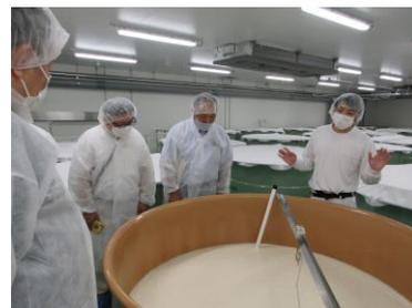
洗米、蒸しの工程を経た米は、仕込みの段階に移る。タンクの中に、酵母と水と麴と米を入れて仕込む。一回でタンク一杯に仕込むこともできるが、そうすると酵母が増える前に雑菌の方が増えてしまう可能性があるため、数回に分けて徐々に米と麴と水を足しながら仕込みを行っている。この工程では、毎朝各タンクのサンプルを取り、その日のアルコール度数や米の溶け方、アミノ酸量などを計測する。そのデータを折れ線グラフにして分析室の壁に掲示し、社員で共有しながら、目指す目標数値に近づけるべく、それぞれのタンクに最適な温度となるよう調整し、厳密な温度管理を行っている。
